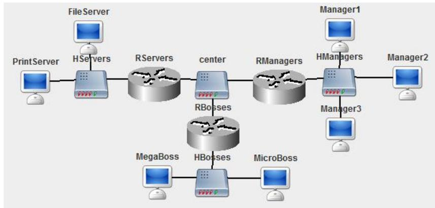
Сеть между маршрутизаторами RServers, RManagers и RBosses: 25.0.0.0. Компьютер MegaBoss имеет максимально возможный IP-адрес в частной подсети класса С. Компьютер Manager3: 172.16.0.72. Компьютер FileServer: 11.16.0.142. Обозначения в задании: K1 – MegaBoss, K2 – Manager2, K3 – FileServer.
