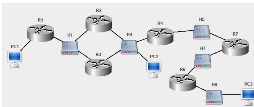
Сеть между узлами R1, R2, R3: 192.168.120.0. Сеть между R4 и R7: 192.168.108.0. Сеть между R6 и R7: 192.168.96.0. Компьютер PC1 имеет IP-адрес 192.168.128.1. Компьютер PC2: 192.168.112.4. Компьютер PC3: 192.115.88.2. Обозначения в задании: K1 – PC1, K2 – PC2, K3 – PC3.
