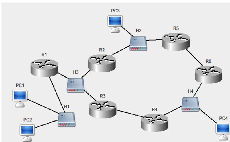
Сеть между роутерами R1, R2 и R3: 192.168.3.0. Сеть между R3 и R4: 192.168.4.0. Сеть между R5 и R6: 192.168.5.0. Компьютер PC2 имеет IP-адрес 192.168.0.10. Компьютер PC3: 192.168.0.40. Компьютер PC4: 192.168.0.70.
