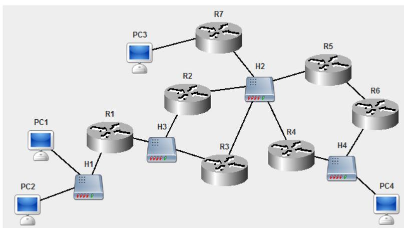
Сеть между роутерами R1, R2 и R3: 172.168.3.0. Сеть между R5 и R6: 172.168.4.0. Компьютер PC2 имеет IP-адрес 172.168.0.100. Компьютер PC3: 172.168.0.120. Компьютер PC4: 172.168.0.140.
