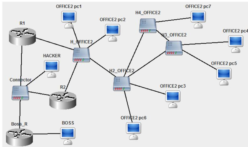
Сеть между маршрутизаторами R1, R2 и Boss\_R: 172.30.0.0. Компьютер Boss: 10.2.130.1. Компьютер OFFICE2\_pc1 имеет максимально допустимый IP-адрес в диапазоне частных адресов класса С.
