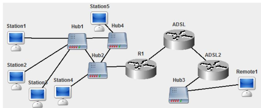
Сеть между маршрутизаторами R1 и ADSL: 172.30.0.0. Компьютер Station1 имеет IP-адрес 192.168.17.202. Подсеть компьютера Remote1: 19.0.0.0. Обозначения в задании: K1 – Station1, K2 – ADSL, K3 – Remote1.
