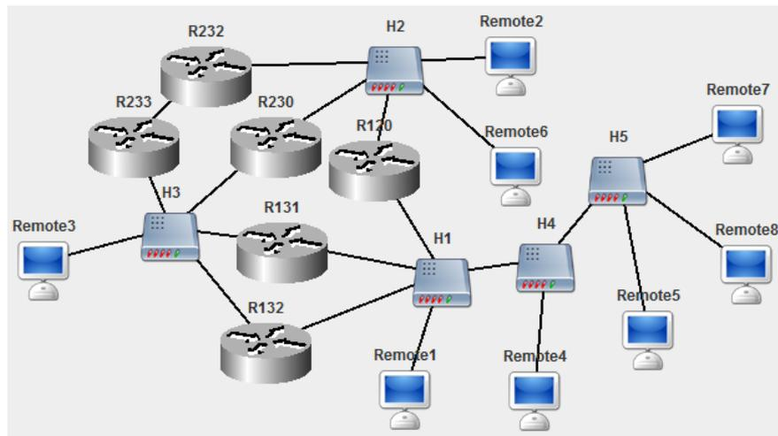
Сеть между маршрутизаторами R120, R230 и R232: 63.0.0.0. Сеть между R232 и R233 имеет наибольший частный адрес класса В. Компьютер Remote1 имеет IP-адрес 168.20.88.0. Компьютеры Remote2 и Remote3 расположены в подсетях класса С.
