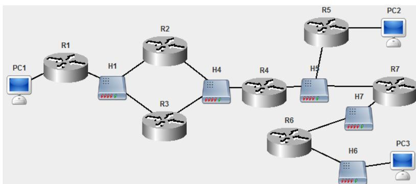
Сеть между узлами R1, R2, R3: 172.16.120.0. Сеть между R2, R3, R4: 172.16.112.0. Сеть между R4, R5, R7: 172.16.108.0. Сеть между R6 и R7: 172.16.96.0. Компьютер PC1 имеет IP-адрес 172.16.128.1. Компьютер PC2: 172.16.100.1. Компьютер PC3: 172.16.88.2. Обозначения в задании: K1 – PC1, K2 – PC2, K3 – PC3.
