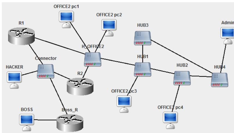
Компьютер Hacker имеет IP-адрес 117.168.131.5. Компьютер Boss имеет IP-адрес 64.17.0.21. Компьютер Admin имеет максимально допустимый адрес узла для частной сети класса В.
