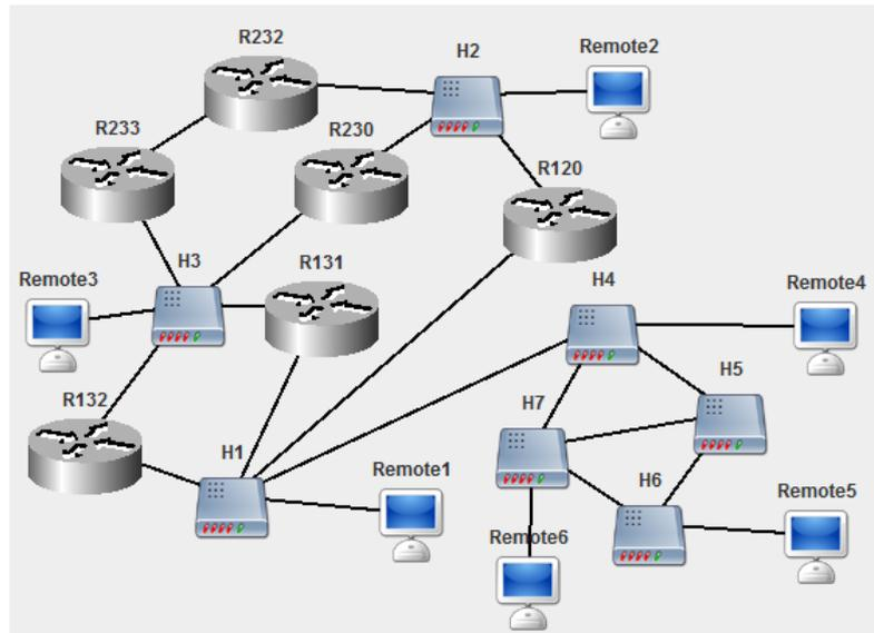
Сеть компьютера Remote2: 72.0.0.0. Сеть между R232 и R233 – частная класса С. Компьютер Remote1 имеет максимально допустимый частный адрес класса С. Компьютер Remote3: 172.31.0.210.
