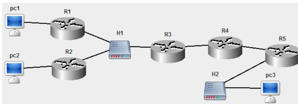
Сеть между узлами R1,R2, R3: 10.0.120.0. Сеть между R3 и R4: 192.168.0.0/24. Сеть между R4 и R5: 192.168.1.0/24. Компьютер PC1 имеет IP-адрес 10.0.0.4. Компьютер PC2: 10.0.0.11. Компьютер PC3: 10.0.0.19.
