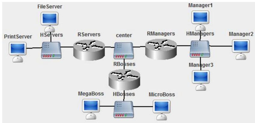
Сеть между маршрутизаторами RServers, RManagers и RBosses — частная 192.168.12.0. Компьютер MicroBoss: 10.0.1.5. Компьютер Manager1: 129.0.1.75. Компьютер PrintServer имеет максимально возможный адрес в частной сети класса С. Обозначения в задании: K1 – Manager3, K2 – PrintServer, K3 – MicroBoss.
