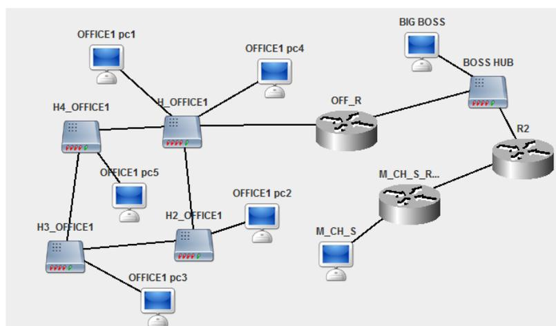
Сеть между маршрутизаторами OFF\_R и R2: 104.0.0.0. Компьютер BIG BOSS имеет минимально возможный IP-адрес в этой подсети. Компьютер M\_CH\_S имеет IP-адрес 174.188.192.129. Компьютер OFFICE1\_pc2 имеет частный IP-адрес класса С. Обозначения в задании: K1 – BIGBOSS, K2 – M\_CH\_S, K3 – OFFICE1\_pc4.
