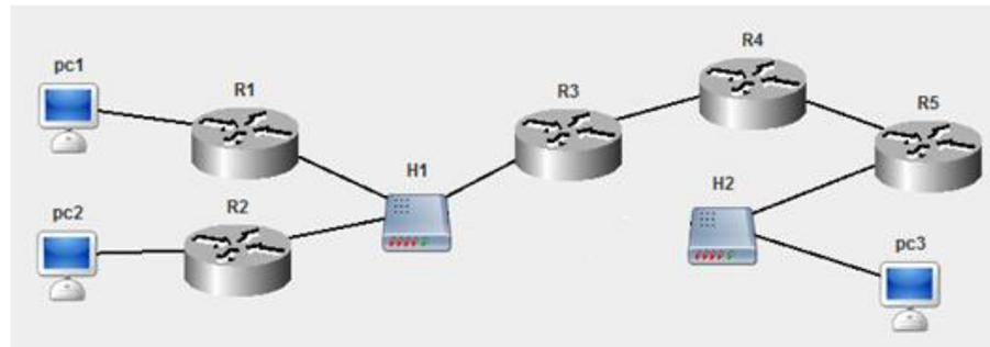
Сеть между узлами R3 и R4: 192.168.0.96. Сеть между R4 и R5: 192.168.0.128. Компьютер PC1 имеет IP-адрес 10.0.0.5. Компьютер PC2: 10.0.0.130. Компьютер PC3: 10.0.0.194.
