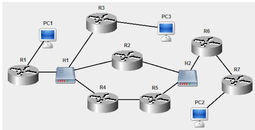
Сеть между роутерами R1, R2, R3 и R4: 199.0.5.192. Сеть между R4 и R5: 172.16.0.128. Маршрутизатор R6 имеет адрес 192.138.0.1 на первом интерфейсе и 192.168.0.10 на втором интерфейсе. Компьютер PC1 имеет IP-адрес 199.0.5.2. Компьютер PC3 имеет IP-адрес 199.0.5.72. Компьютер PC4 имеет IP-адрес: 199.0.5.250.
