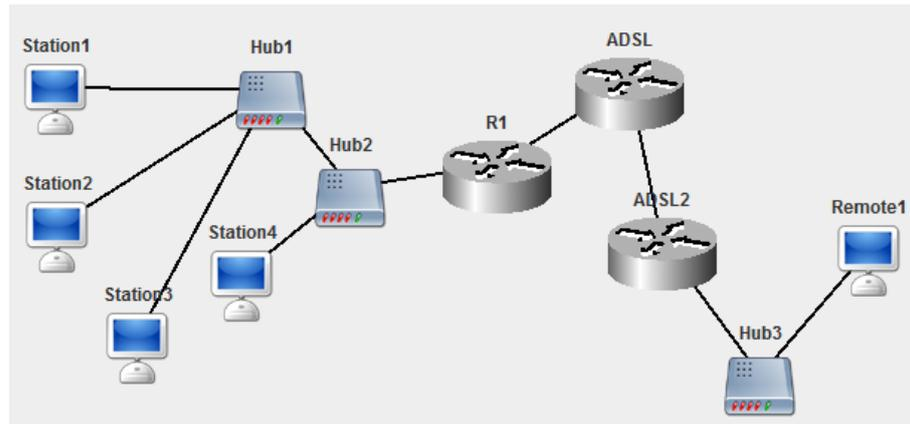
Сеть между маршрутизаторами R1 и ADSL: 192.168.200.0. Компьютер Station1 имеет IP-адрес 172.18.1.191. Компьютер Remote1 имеет IP-адрес 17.8.1.195. Обозначения в задании: K1 – Station1, K2 – ADSL, K3 – Remote1.
