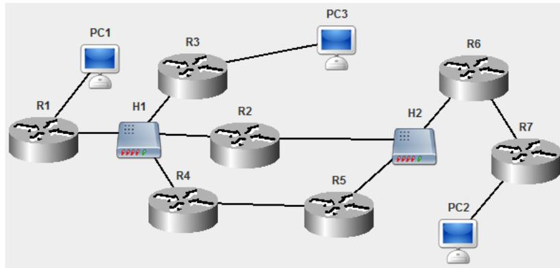
Сеть между роутерами R1, R2, R3 и R4: 192.168.0.96. Сеть между R4 и R5: 172.168.4.0. Маршрутизатор R6 имеет адрес 10.120.0.39 на первом интерфейсе и 10.120.0.139 на втором интерфейсе. Компьютер PC1 имеет IP-адрес 192.168.0.4. Компьютер PC2: 192.168.0.34. Компьютер PC3: 192.168.0.234.
