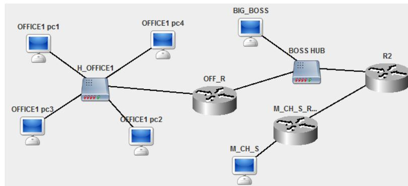
Сеть между маршрутизаторами OFF\_R и R2: 136.0.0.0. Компьютер BIG\_BOSS имеет максимально допустимый в данной подсети IP-адрес. Компьютер M\_CH\_S имеет IP-адрес из диапазона частных адресов класса В. Компьютер OFFICE1\_pc1: 192.168.5.130.
