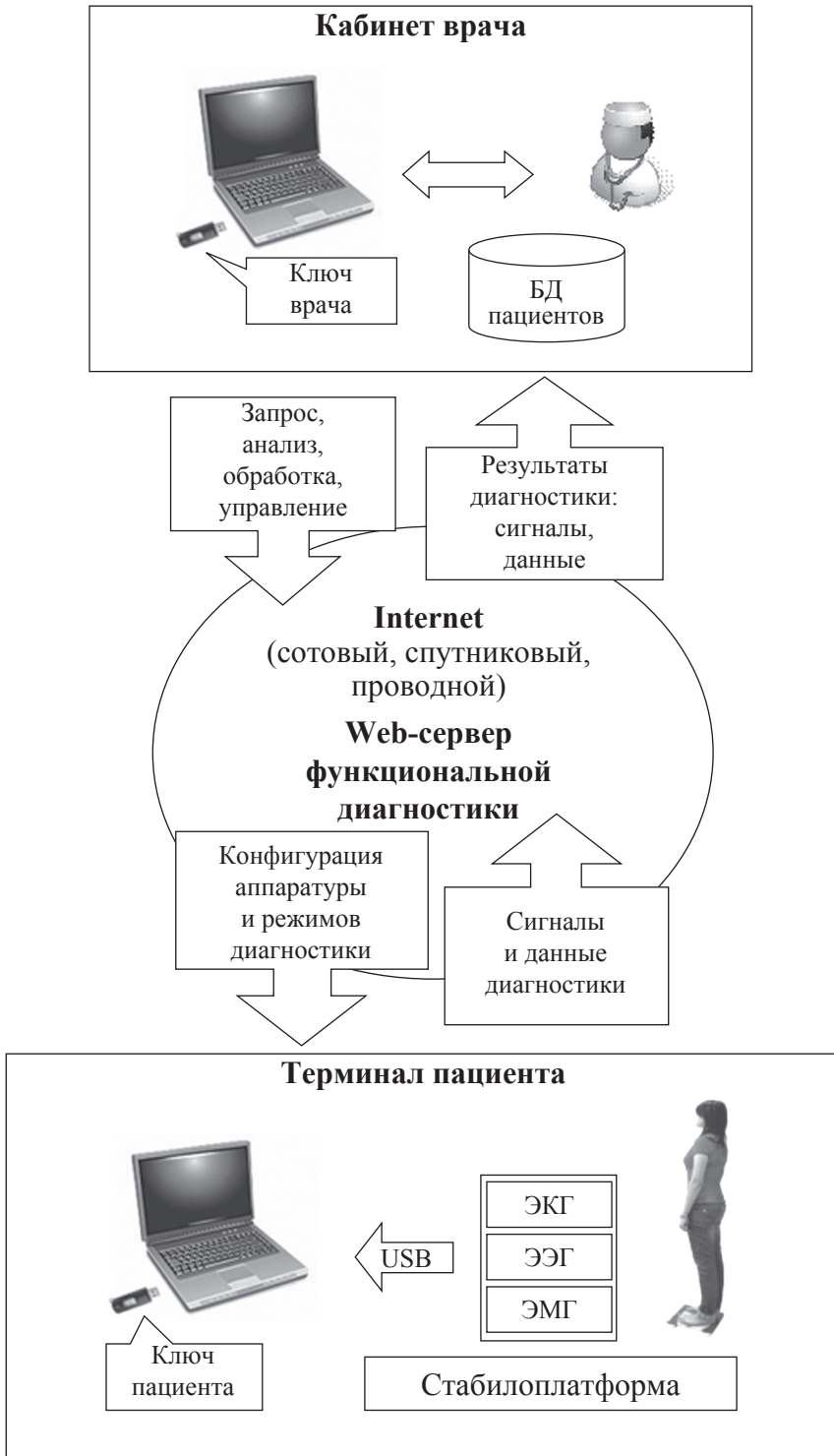
Рис. 4. Функциональная схема ВебМультимедик [1]
