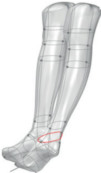
*Рис. 3.* Фрагмент параметризации 3D модели ног (обхватные измерения)
