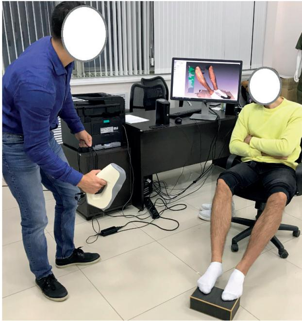
*Рис. 2.* Сканирование ног сенсором Artec 3D Eva
