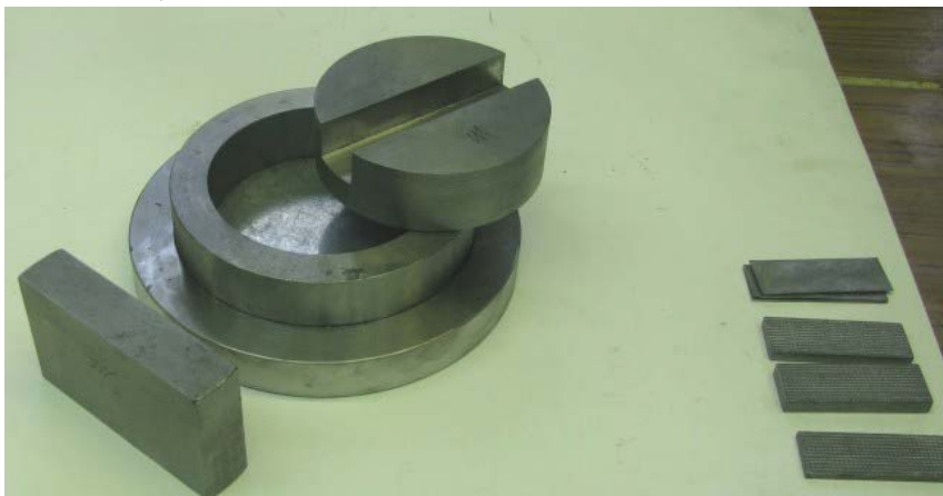
Рис. 20. Штамповая оснастка для проведения экспериментов по пластической осадке тонких прямоугольных образцов
