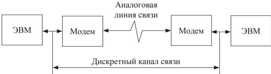
Рис. 1.3. Дискретный канал связи
