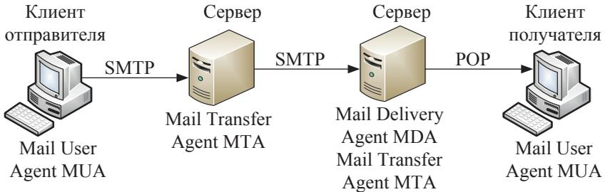
*Рис. 3.18.* Передача электронной почты по сети
