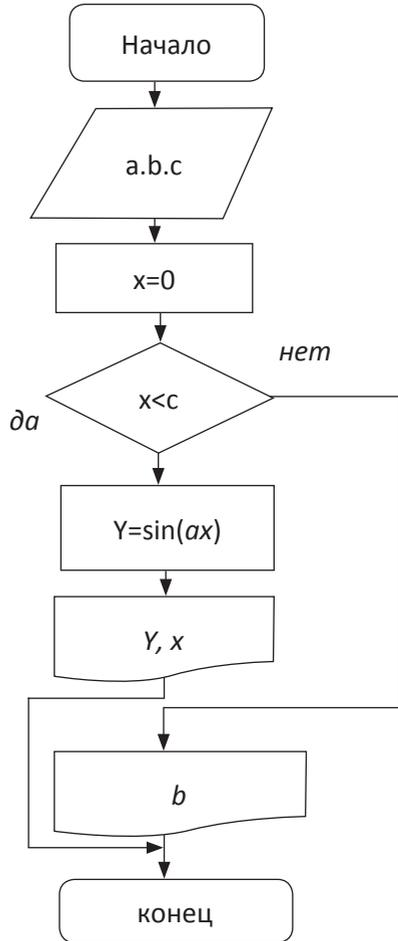
Рис. 2. Блок-схема алгоритма с одним разветвлением
