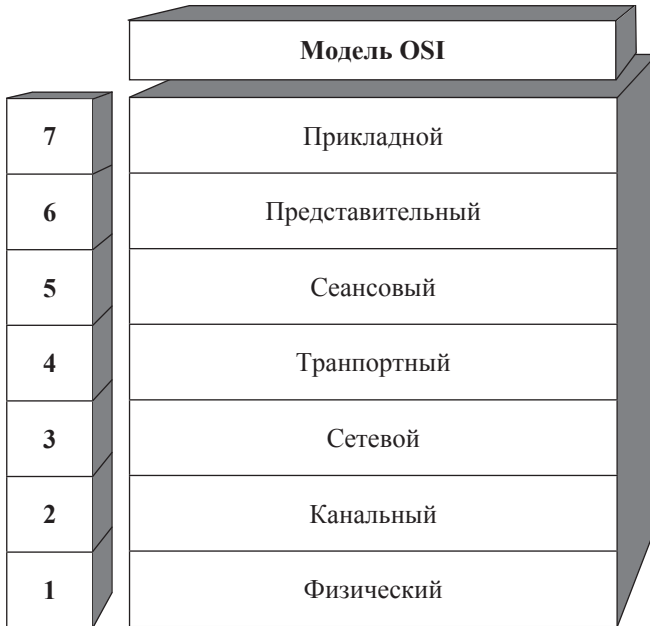
Рис. 2.8. Эталонная модель архитектуры открытой системы
