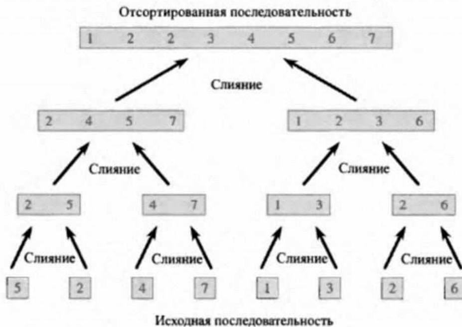
Рис. 2.4. Процесс сортировки слиянием массива A = \langle 5, 2, 4, 7, 1, 3, 2, 6 \rangle . Длины подлежащих слиянию отсортированных последовательностей возрастают в ходе работы алгоритма.
