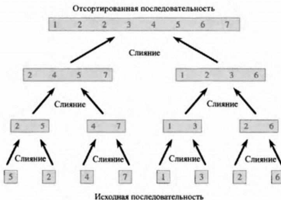
Рис. 2.4. Процесс сортировки слиянием массива A = \{5, 2, 4, 7, 1, 3, 2, 6\} . Длины подлежащих слиянию отсортированных последовательностей возрастают в ходе работы алгоритма.
